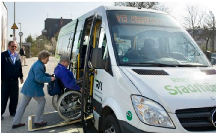
Der Kleinbus ermöglicht einen leichten Ein- und Ausstieg dank Rampen, breiter Türen und Absenkfunktion.
