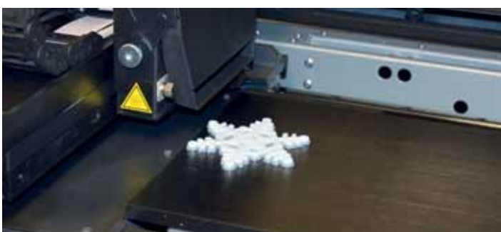
Ca. 1,5 Std. dauert der Druck des Sterns (ø 80 mm, 3 mm dick). Die Kosten belaufen sich auf etwa 5,- Euro.
