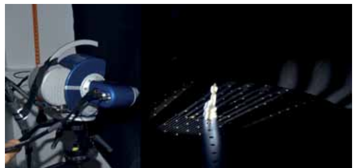
Der 3D-Scanner zerlegt ein Objekt mit Hilfe von Licht.
