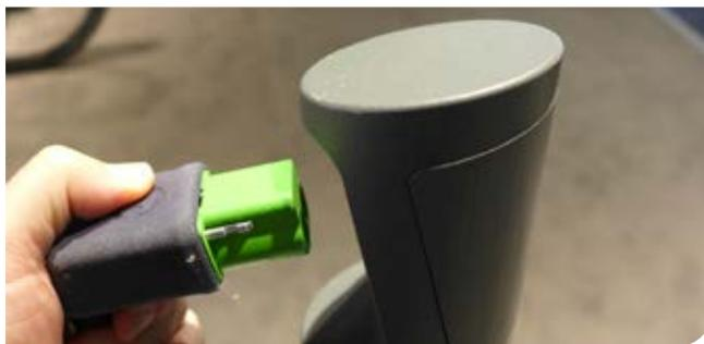
Abbildung 40: Prototyp einer Ladesäule mit neuem Ladestecker
