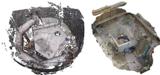
Abb. 1: Punktwolke bzw. texturierte Dreiecksvermaschung zweier Baugruben
