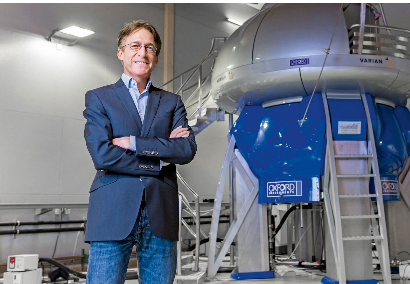
Prof. Dieter Willbold vor dem 900-MHz-NMR-Spektrometer – einem Gerät, das dazu dient, komplexe dreidimensionale Strukturen von Molekülen aufzuklären
