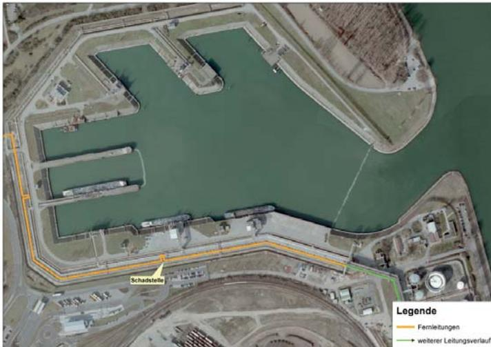
Ursprünglich wurde der Bau von drei Rohrfernleitungen für die Produkte Naphtha, Propylen und Ethylen auf der Trasse von der Raffinerie in Karlsruhe zur BASF SE nach Ludwigshafen beantragt. Gegenstand der erteilten Genehmigung und damit Teil der Rohrfernleitungsanlagen war auch der etwa 700 m lange oberirdische Verlauf im Rohrgraben entlang des Nordhafens, beginnend von der Werksgrenze der BASF SE bis zur Übergabestation im östlichen Teil des Hafens.
