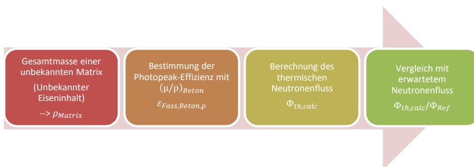
**Abbildung 8.7:** Schritte der Methode zur Bestimmung des thermischen Neutronenflusses in einer Betonmatrix mit unbekanntem Eisengehalt.
