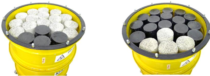
**Abbildung 2.4:** Asymmetrische Beladung eines 200 l RRW-Stahlfasses mit 60 Beton- und 16 PE-Körpern (links) sowie einer Beladung mit 60 PE- und 16 Beton-Körpern (rechts).
