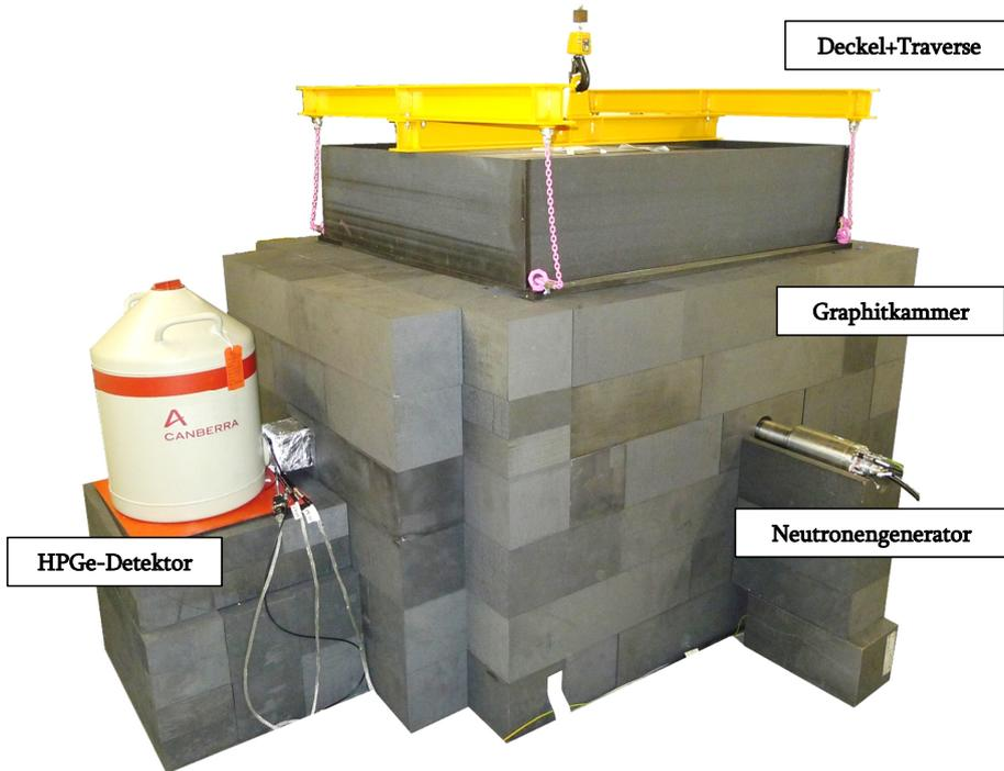
**Abbildung 2.1:** Die MEDINA-Einrichtung mit ihren wesentlichen Komponenten. Hierzu zählen die Graphitkammer, das  $\gamma$ -Spektrometer mit einem HPGe-Detektor, der Neutronengenerator und die Krankonstruktion (Deckel+Traverse).
