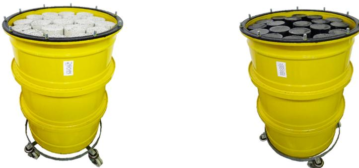
**Abbildung 2.3:** Das 200 l RRW-Stahlfäss mit 76 Betonkörpern (links) und mit 76 PE-Zylinder (rechts) befüllt.
