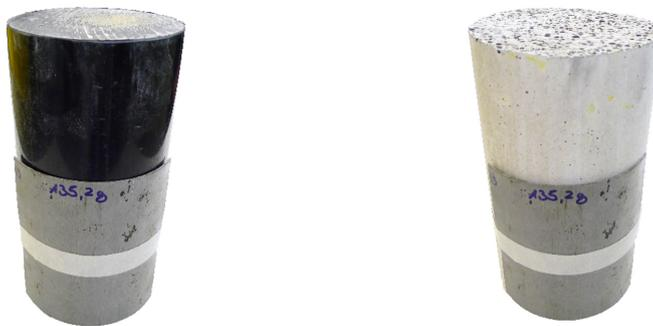
**Abbildung 2.5:** Cd-Blech fixiert an einem PE-Körper (links) und an einem Beton-Körper (rechts).
