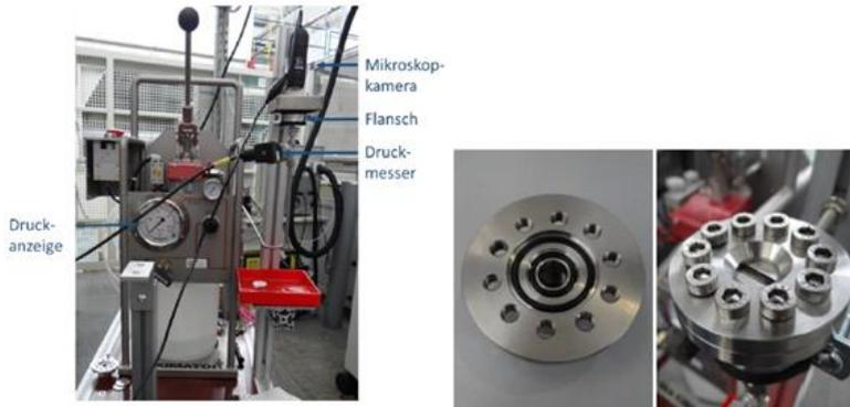
**Abb. 55: Versuchsaufbau des Flow Field Versuchs (links) und Testzelle (rechts)**
