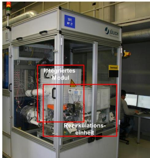
**Abb. 19: Rezyklereinheit mit 5 kW Integriertem Modul im System**
