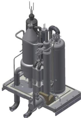
**Abb. 71: Aufbau des Packages 5 mit einer Leistungsklasse von 10 kW<sub>e</sub>**
