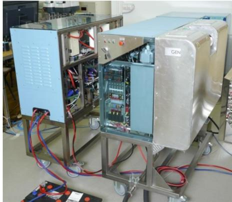
**Abb. 30: FCGEN-System mit einer elektrischen Leistung von 3-5 kW, links ist der Brennstoffzellenteil zu sehen, rechts der Fuel Processor**
