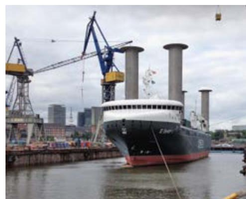
**Das E-Ship 1 mit seinen vier Flettner-Rotoren setzt auf die Energie des Windes (links und unten).**
