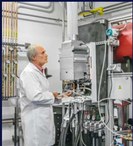
Ob Gasheizung oder -herd, Durchlauferhitzer oder Absorptionskühlschrank – Geräte, die zum Kochen und Heizen, zur Warmwasserversorgung oder zu Kühlzwecken genutzt und mit gasförmigen Brennstoffen betrieben werden, müssen vor allem eines sein: sicher. Im Mailänder Global Technology Assessment Center werden sie genau darauf geprüft.
