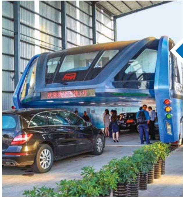
Die große Fahrgastzelle des Transit Elevated Bus befindet sich rund zwei Meter über dem Boden. Auf Schienen gleitet sie über den Straßenverkehr hinweg, die Autos fahren einfach darunter hindurch. Das futuristische Gefährt soll auf Chinas Straßen für Platz sorgen. Ein Modell spiegelt die Größe des Buses wider (Foto links).
