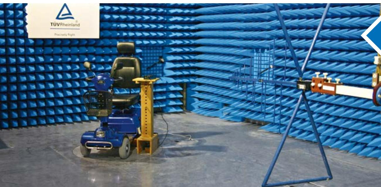
**Neben Mechanik und Haltbarkeit werden die Testobjekte auch auf elektrische Sicherheit und elektromagnetische Beeinflussung geprüft. Ein Prüfbericht besiegelt die absolvierten Tests.**
