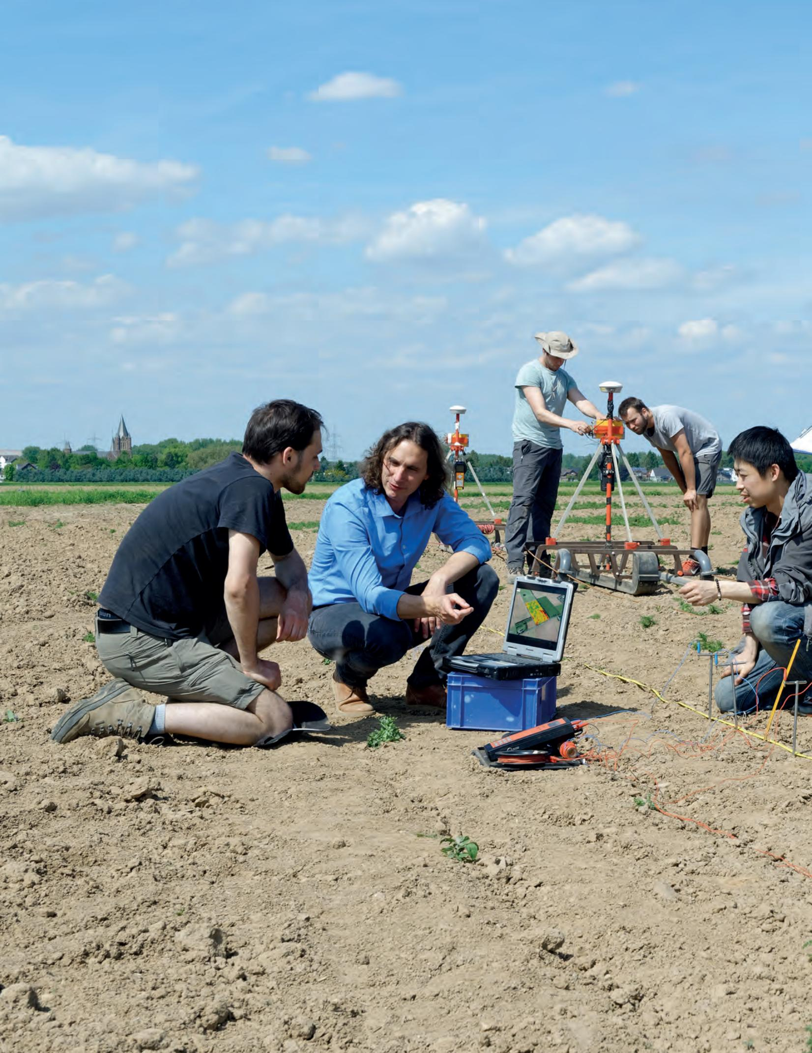
Bild 2: Geophysikalische Feldmessungen, elektrische Widerstandsmessungen (Vordergrund) und Bodenradarmessungen (Hintergrund), zur Analyse von oberflächennahen Strukturen auf einer landwirtschaftlich genutzten Fläche bei Düren in einem Projekt mit dem Forschungszentrum Jülich (IBG-3).
