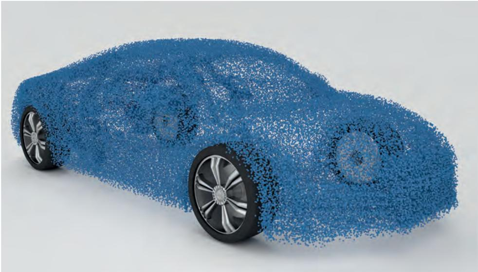
Bild 1: 3D-Laserscanner tasten ein Objekt ab und erzeugen Rohdaten in Form einer dichten Punktwolke.
