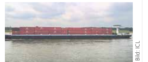
Das Gütermotorschiff „Anda“ ist 135 Meter lang, 11,45 Meter breit und kann maximal 3.878 Tonnen laden
