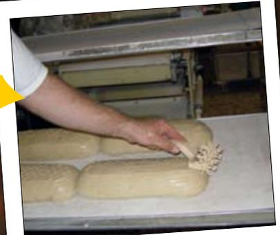
9. Das Brot wird, bevor es in den Etagenofen kommt, auf Dielen gekippt, mit Wasser abgestrichen und gestippt, damit er nicht rissig wird und die Oberfläche beim fertigen Brot schön glänzt.
