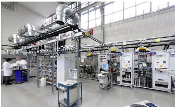
Abb. 25: Die im Jahr 2014 fertiggestellte Bühne mit den HT-PEFC Testständen
