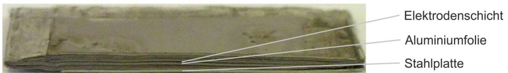
**Abbildung 34:** Abbildung einer vorgeschliffenen Schichtelektrode, die nach dem zuvor beschriebenen Schema hergestellt wurde.
