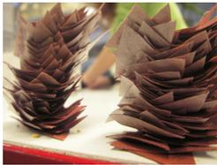
**Der Zuschnitt der Einbandmaterialien** kann nun nach den Maßen der fertigen Buchblöcke erfolgen. Die Zuschnearbeiten werden auf der **Pappschere** durchgeführt. Diese funktioniert nach dem Scherenschnittprinzip. Ihr Arbeitstisch ist 80 x 120 cm groß. Es können große Pappen und Gewebe aus 1 Meter breiten Rollenbahnen zugeschnitten werden.
