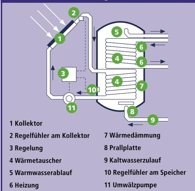
Wenn die Sonnenenergie dann witterungsbedingt nicht mehr ausreicht, um den Warmwasserbedarf vollständig abzudecken, sorgen die Kollektoren für die Vorerwärmung des kalten Wassers (beispielsweise von 12°C auf 30°C), den Rest liefert Ihr Heizkessel.
