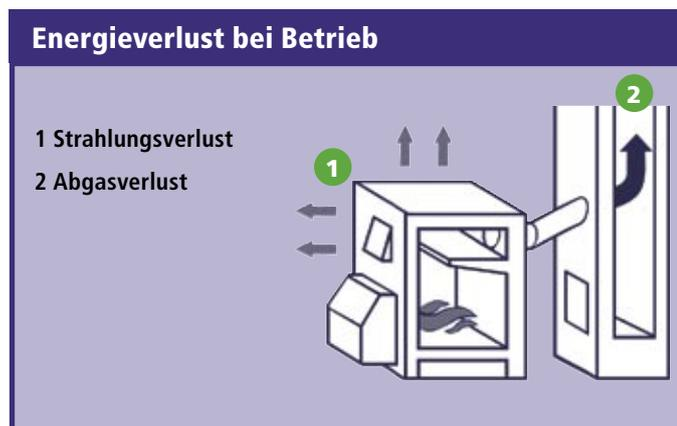
Fast alle älteren Anlagen nutzen die eingesetzte Energie sehr schlecht aus. Es ist keine Seltenheit, dass der Jahresnutzungsgrad (Brennstoffausnutzung) unter 70 Prozent liegt. Dies liegt häufig auch daran, dass alte Heizkessel zu groß ausgelegt wurden und noch nicht über die neueste Technik (Niedertemperatur- und Brennwerttechnik) verfügen.
