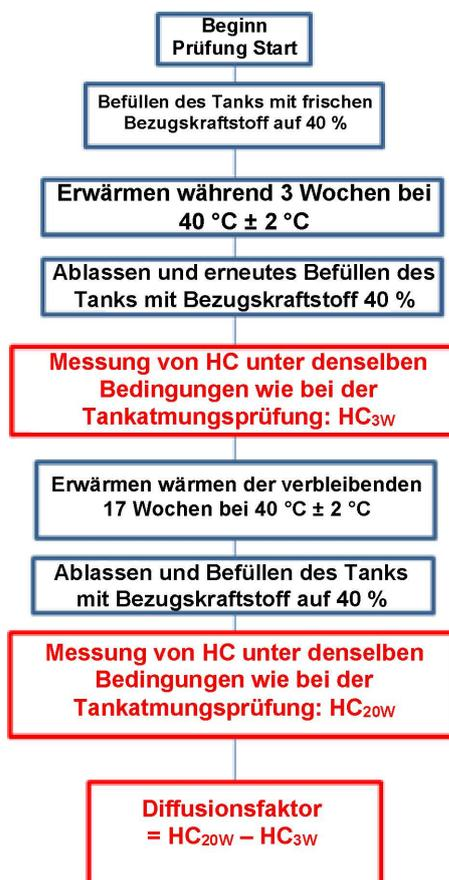
Das für eine Familie repräsentative Kraftstoffspeichersystem wird ausgewählt und an einer Vorrichtung angebracht und dann 20 Wochen lang bei  $40\text{ °C} \pm 2\text{ °C}$  mit dem E10-Bezugskraftstoff durchtränkt. Die Ausrichtung des Kraftstoffspeichersystems auf der Vorrichtung muss der tatsächlichen Ausrichtung auf dem Fahrzeug entsprechen.
