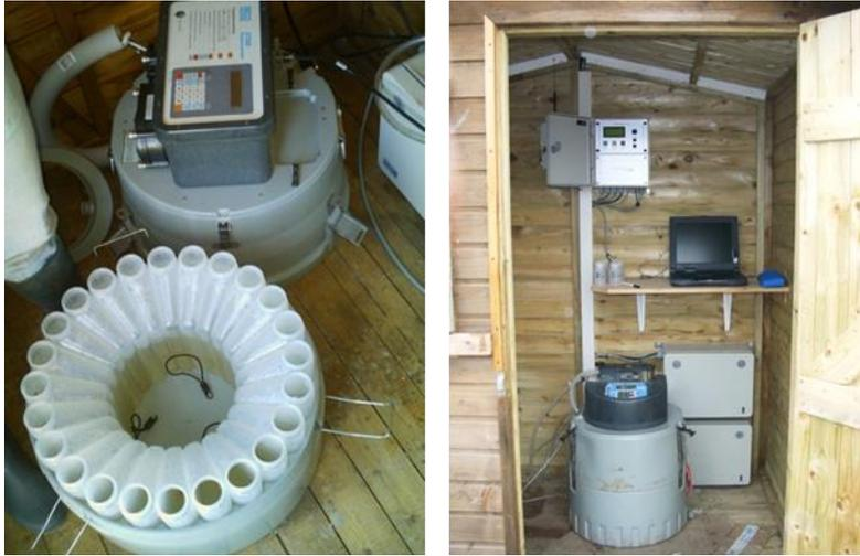
Abbildung 44: Geöffneter Autosamplereimer (Teledyne Isco, Inc., Lincoln, USA) mit 24 Probenflaschen (links) und geschlossener Autosamplereimer in Messhütte (im Hintergrund Datenlogger (UGT, Müncheberg, D) und Boxen mit Autobatterien zur Stromversorgung, rechts); Foto: B. Tiemeyer
