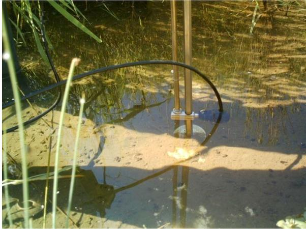
Abbildung 40: Induktives Durchflussmessgerät im Einsatz, Foto: B. Tiemeyer
