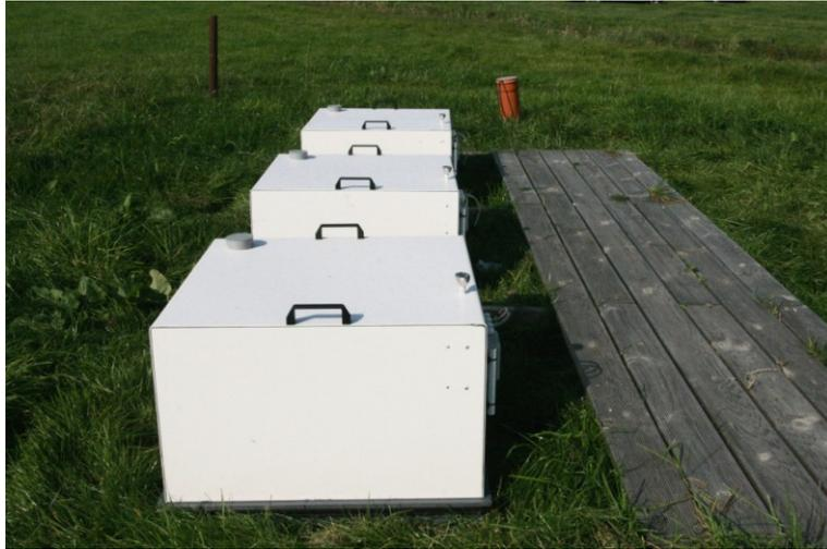
Abbildung 56: Nicht-transparente Hauben zur Messung von Methan und Lachgas (Foto: B. Tiemeyer)
