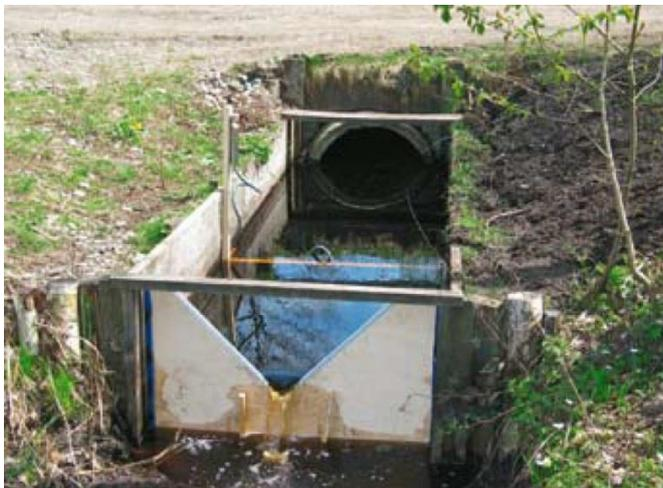
Abbildung 39: Beispiel für ein Messwehr (BAFU, 2009)
