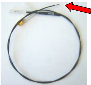
Abb. 1: 5.6 French Katheter ( \ell=80 cm) mit Mikrospule (Pfeil) und SMA-Stecker zur Verbindung mit dem Anpassnetzwerk.
