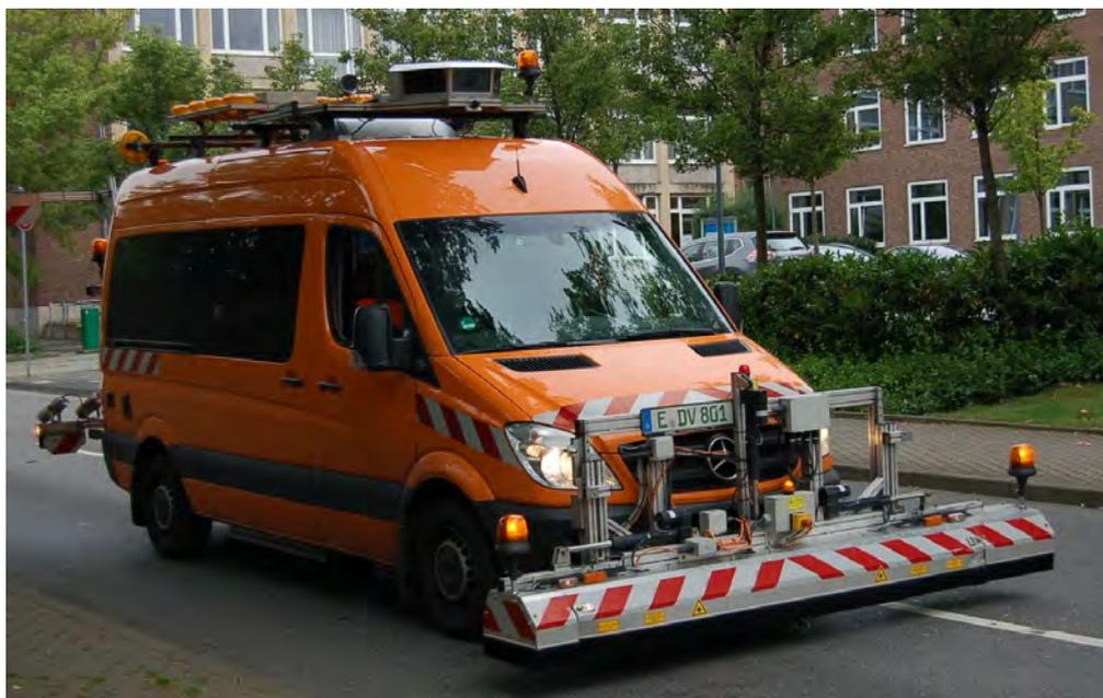
*Die 32 Laser, die in der 3,20 Meter breiten Vorrichtung vor der Frontstoßstange stecken, tasten die Straßenoberfläche millimetergenau ab; alle Unebenheiten, Schlaglöcher und Risse sowie weitere Merkmale werden von den Messgeräten registriert. Das funktioniert bis zu einer Geschwindigkeit von 80 km/h. Alle Messwerte werden aufbereitet und fließen mit Kamerabildern und Geo-Daten verknüpft, in die Datenbank des Amtes.*
