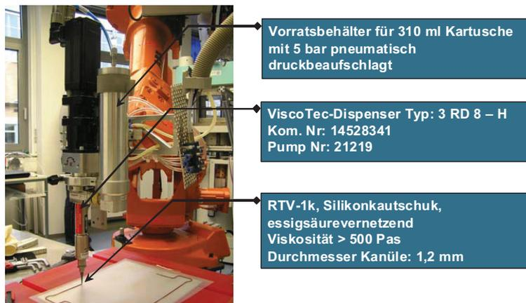
**Abb. 32: Dispergieranlage für Sechs-Achs-Knickarmroboter**
