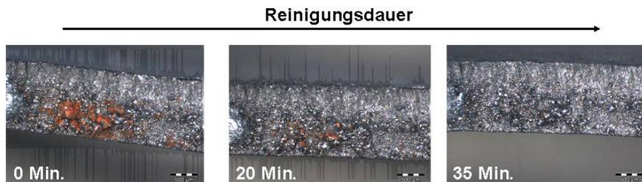
**Abb. 26: Reinigung des Sigrflexmaterials mit Oxalsäure/Wasser-Mischung**
