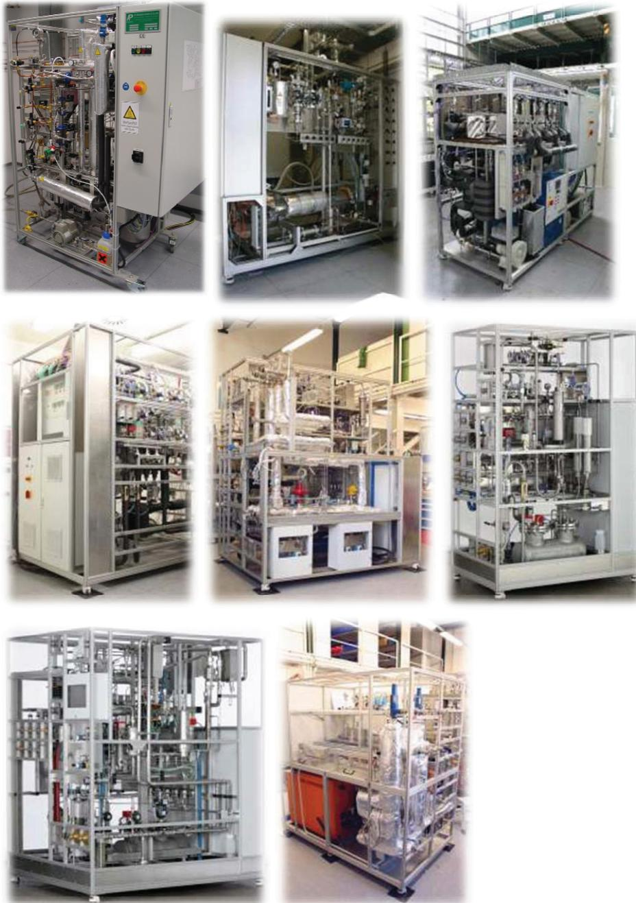
**Abb. 70: Testmodule DeS I, DeS II zur Entschwefelung und, Module A – E zum Test von Reformern, Shiftreaktoren, Brennern und HT-PEFC Stacks**
