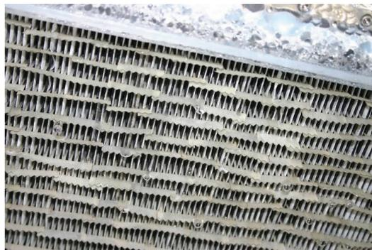
**Abb. 120:** Integration der Kammstrukturen in den Kathodenauslass des Stacks
