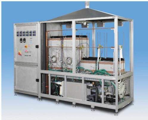
Entwicklung und Bau von Anlagen: Um die Machbarkeit der Technologie zu demonstrieren und das Zusammenspiel aller Komponenten zu erproben, wird eine SOFC-Demonstrationsanlage entwickelt und gebaut, die im Erdgasbetrieb eine elektrische Leistung von 20 kW abgeben soll.
