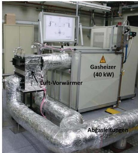
Abb. 59: Aufbau für Luftvorwärmer teststand
