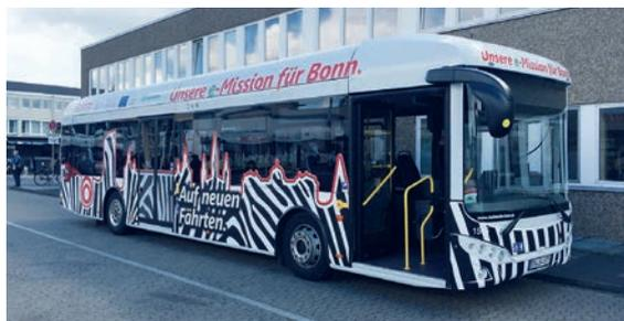
Wiederum andere, z. B. die Stadtwerke Bonn und 2017 auch die Aachener Straßenbahn und Energieversorgungs-AG (ASEAG), setzen ausschließlich auf Übernachtladung. Hierbei werden die vollelektrischen Busse bereits erfolgreich im Linienbetrieb eingesetzt. Dieses System hat den Vorteil, dass auf der Strecke keine Ladeinfrastruktur gebaut werden
