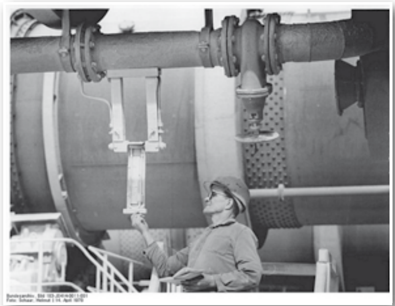
Schwefelsäure-Herstellung zu DDR-Zeiten im Chemiekombinat Bitterfeld – an einem der riesigen Drehrohröfen überwacht der Chemiarbeiter Rudi Birkner die Produktion. In Bitterfeld wurde die Säure aus Gips und Kohle hergestellt; mit Zusatz von Sand und Ton fiel dabei als Nebenprodukt Zement ab.
