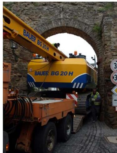
Die Firma Gollwitzer, die als statische Sicherungsmaßnahme der Stadtmauer eine Bohrpfehlwand errichtet, schickte einen Schwertransporter aus Süddeutschland auf den Weg nach Bad Münstereifel. Auf diesem Schwertransporter wurde ein Bohrgerät transportiert, welches die 72
