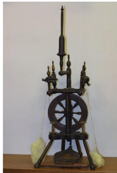
Es sind **Doppelflügelspinnräder**, bei denen die beiden Spinnflügel aus Spinnflügel und Spule nebeneinander angeordnet und über jeweils eine Doppelschnur mit dem Antriebsrad verbunden sind. Der Radkranz des Antriebsrades ist deshalb breiter als bei normalen Spinnrädern und hat zwei Rinnen, die durch einen Damm getrennt werden. Dieser Damm hält die beiden Schnurpaare voneinander getrennt. An einem solchen Rad kann also eine Person gleichzeitig mit beiden Händen jeweils einen Faden spinnen, was
