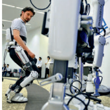
Der Exoskelettanzug HAL® wurde entwickelt, um Menschen mit physischen Behinderungen zu unterstützen.
