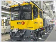
Die neuen Fahrzeuge besitzen die Spurweite von 1.435 Millimetern und können auf Steigungen von bis zu 60 Promille eingesetzt werden. Sie dienen dem Materialtransport von Schotter, Sand, Schienen, Schwellen, Oberleitungsmasten, Kleisenen, Schutt, Fertigbetonteilen, Kabeltrommeln, Fahrtreppen, Schaltschränken und Reinigungsgeräten.
