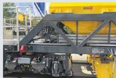
Zwei der Gleiskraftwagen sind mit einem Ladekran ausgestattet, der mit Höhenbegrenzung und Gegengewichtssperre ausgerüstet ist. Die maximale Ausladung beträgt 10,4 Meter.
