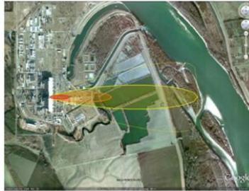
Abbildung 51: Beispiel für die Ausbreitung eines an einem Quellort freigesetzten Spurenstoffes gemäß des Gaußschen Fahnenmodells.
