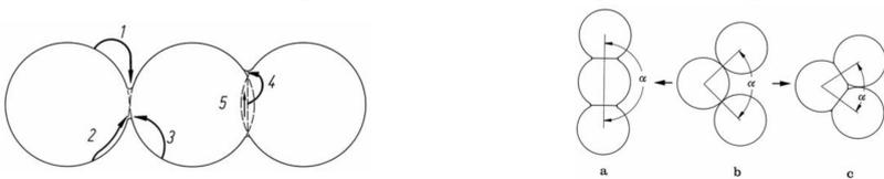
Abb. 2.12 Links: Unterschiedliche Materialtransportwege zum Sinterhals: Der Transport kann über Oberflächendiffusion (2), Volumendiffusion, ausgehend von der Oberfläche (3) oder Korngrenze (4) und als Grenzflächendiffusion (5) entlang einer Korngrenze stattfinden; Rechts: Drei-Kugel-Modell mit nichtlinearer Ausgangsanordnung (b), die sich entweder zur Großwinkelkorngrenze (a) oder Kleinwinkelkorngrenze entwickeln kann [66]
