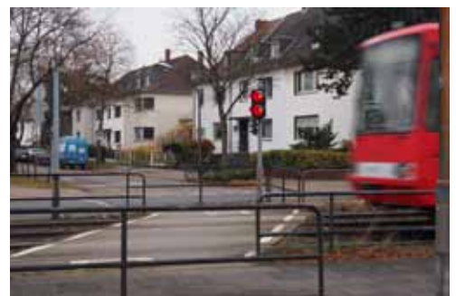
Die Bahn hat den Überweg passiert. Das Nachleuchten des Rotsignals hat keine Funktion und erzeugt Missverständnisse. [Foto: R. Zietz]
