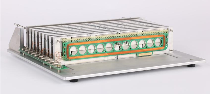
**Abb. 4.1:** Seitenansicht des PCB-Luftspulen-Aktuator-Systems ohne Aluminiumoberfläche.
