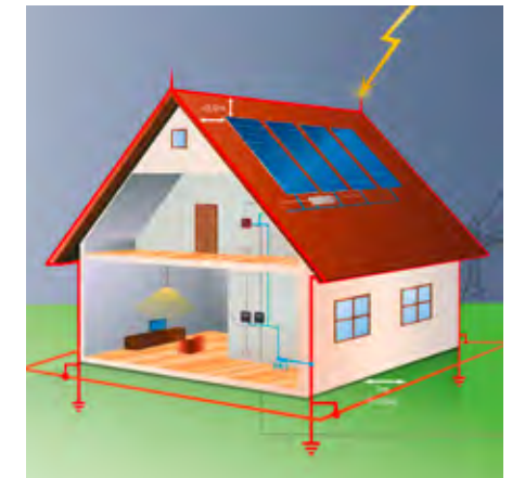
Äußere Blitzschutzsysteme bestehen aus Auffangvorrichtung, senkrechter Ableitung und Erdungsanlage.
