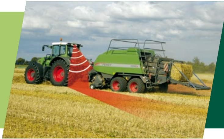
Bereichserfassung mit rückwärtig ausgerichtetem 3D Time-of-Flight Kameraassistenzsystem
