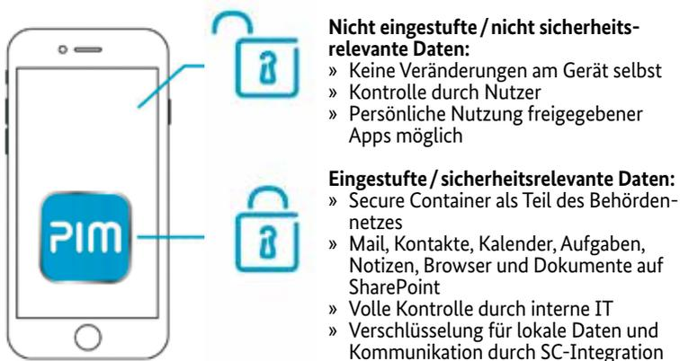
Abbildung 8: SecurePIM – Secure-Container-Konzept
