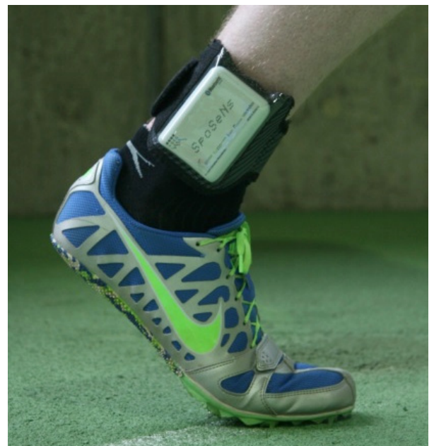
Abb. 1: Sensor-Knoten am Knöchel des Sportlers.
