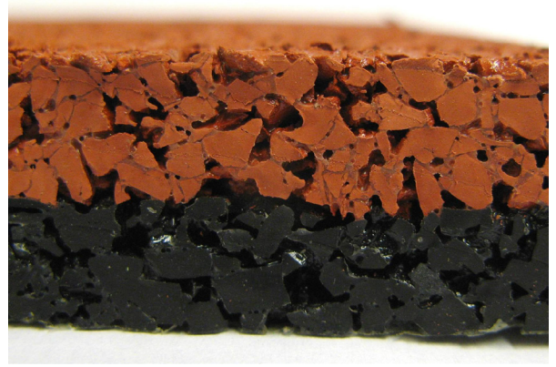
Abb. 1 links: Säulenversuche mit einem verfüllten Kunstrasensystem einschließlich der gebundenen elastischen Tragschicht mit Altreifengranulat und der ungebundenen Tragschicht. Die einzelnen Schichten sind in umgekehrter Reihenfolge eingebracht, da die Fließrichtung von unten nach oben erfolgt. rechts: Schnittfläche eines Sportbelages auf Kunststoffbasis (unten Altreifengranulat gebunden mit Polyurethan, oben Schüttbeschichtung mit Ethylen-Propylen-Dien-Kautschuk)
