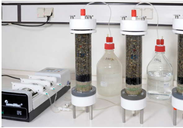
Abb. 1 links: Säulenversuche mit einem verfüllten Kunstrasensystem einschließlich der gebundenen elastischen Tragschicht mit Altreifengranulat und der ungebundenen Tragschicht. Die einzelnen Schichten sind in umgekehrter Reihenfolge eingebracht, da die Fließrichtung von unten nach oben erfolgt. rechts: Schnittfläche eines Sportbelages auf Kunststoffbasis (unten Altreifengranulat gebunden mit Polyurethan, oben Schüttbeschichtung mit Ethylen-Propylen-Dien-Kautschuk)
