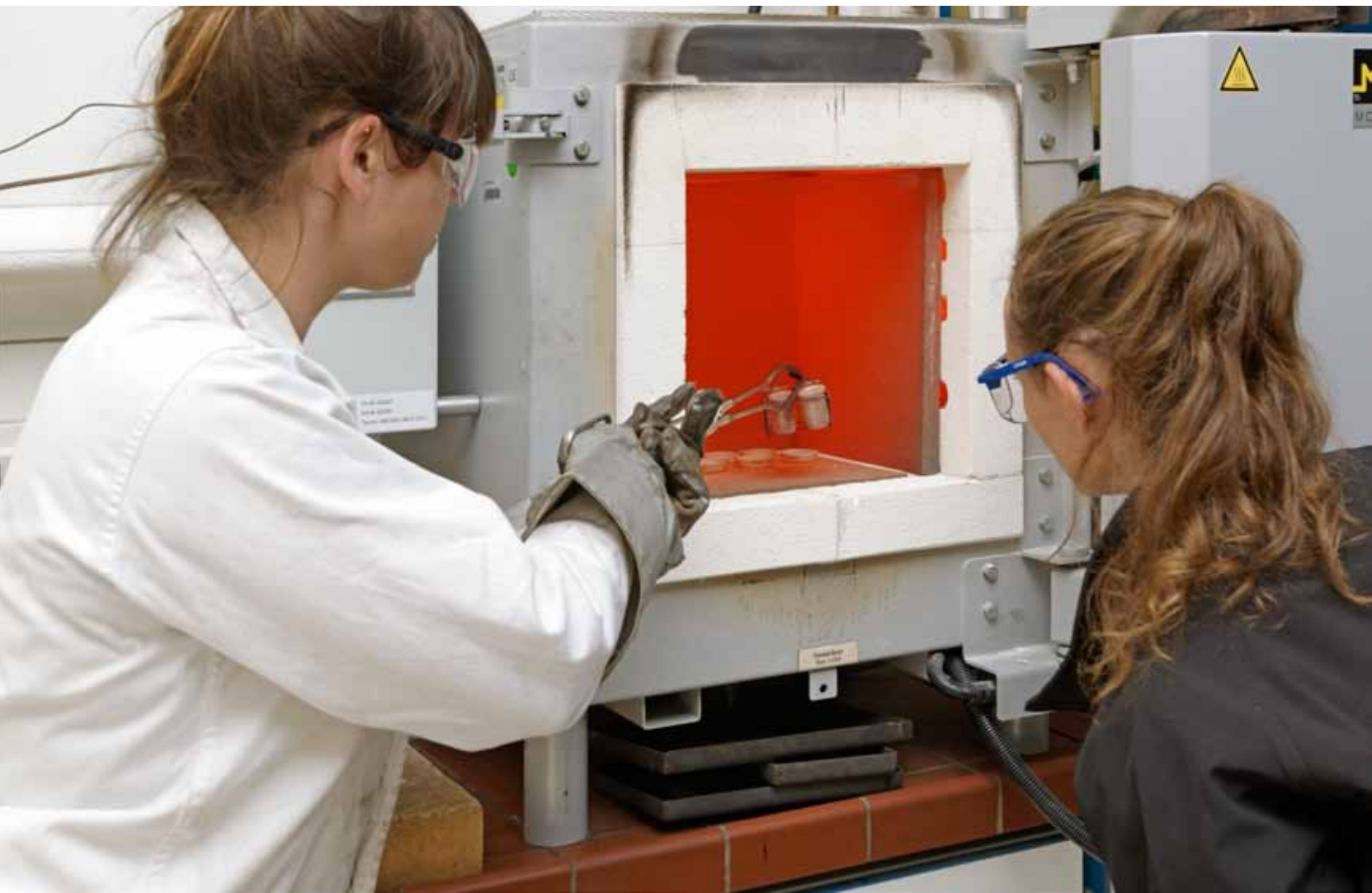
Bild 4: Brennstoffanalytik am Muffelofen: Bestimmung von flüchtigen Bestandteilen im Brennstoff. Foto: Peter Winandy
