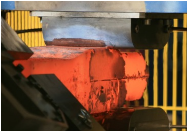
Bild 6: Umformung eines Gussblocks an der Schmiedepresse.
