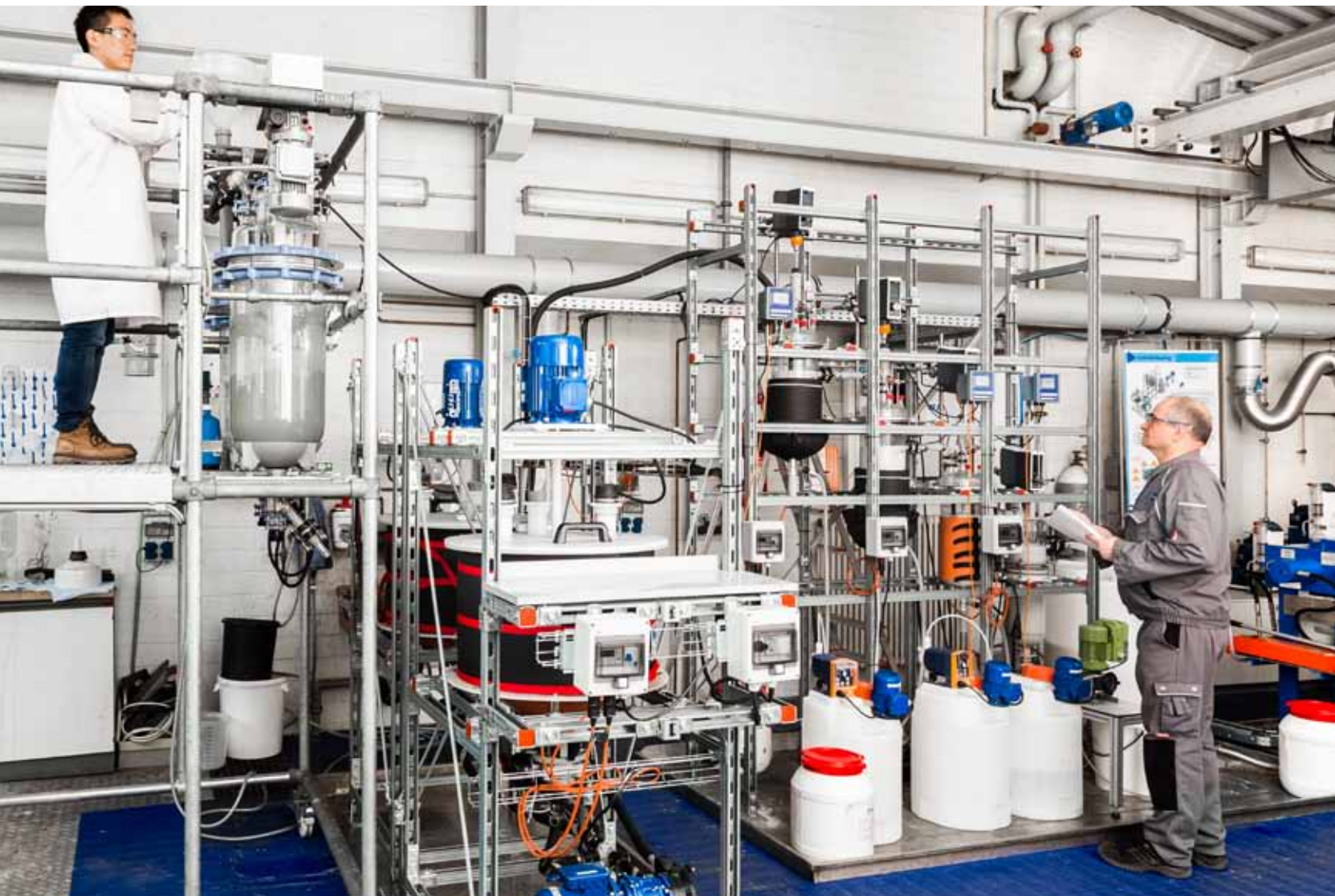
Bild 3: Nass-Chemische Wertmetall-Rückgewinnung aus Elektronikschrott in der Kaskadenstraße. Foto: Martin Braun
