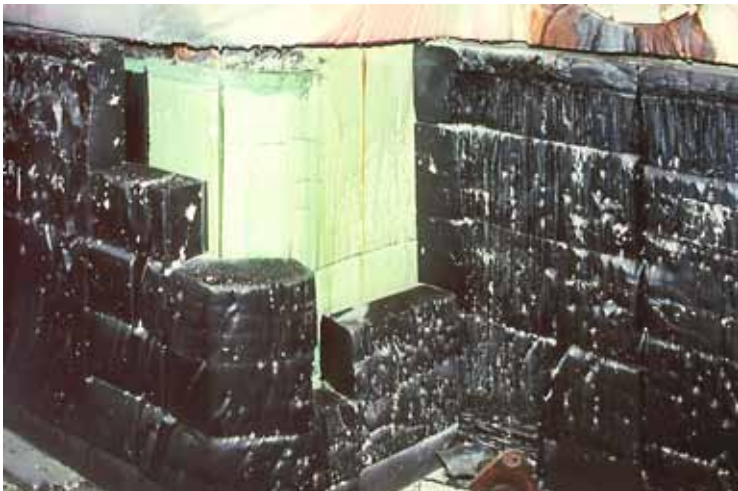
Bild 3: Nahezu unangegriffene ZrO_2 -Hintermauerung (grüngelb) einer Faserglaswanne mit Chromoxid-Steinen (schwarz). Idealer Fall für Recycling.
