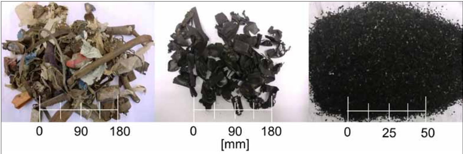
Bild 3: Ausgangsmaterial (links), Metallprodukt (mitte) und Koks (rechts) aus der Pyrolyse von Metallkonzentraten aus Deponiematerial bei 600 Grad Celsius [9] .
