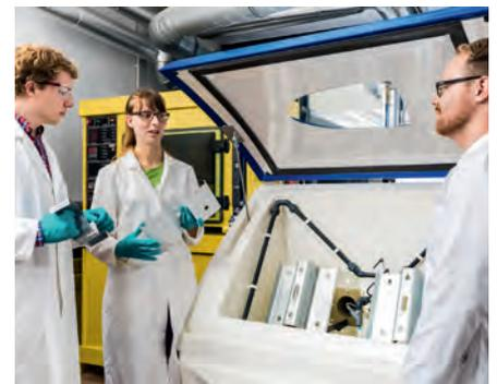
Studierende beurteilen mit der industrienahen Klimakammer korrosionsgeprüfte Bauteile.
