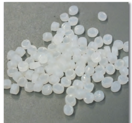
Bild 4: PE-HD, das Ausgangsmaterial, mit dem die Fränkischen Rohrwerke seit Jahrzehnten ihre hoch belastbaren Kunststoffrohre für Trinkwasser- und Heizungsanwendungen herstellen.
