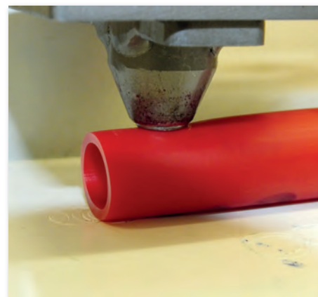
Bild 6: Um die Fertigungsqualität der FRÄNKISCHE-Produkte zu überprüfen, werden die Proben durch Stanzen präpariert.
