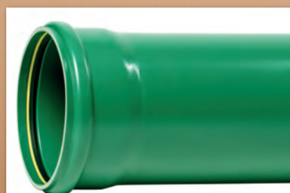
Bild 6: Das neue Abwasserrohr-System „GreenTube SN 10“ von Alphacan Omniplast: gut zu erkennen die bewährte, aber hochwertig optimierte, doppelwandig-bio-nische Sandwichkonstruktion mit dem homogen gefüllten, geschlossenporigen Zellkern. Innen die gelb-schwarze HB-FIX Lippendichtung – ein „Nahezufest“-Dicht-ring, der absolut treibstoff- und mineralöl-beständig sowie dicht und wurzelfest ist.
