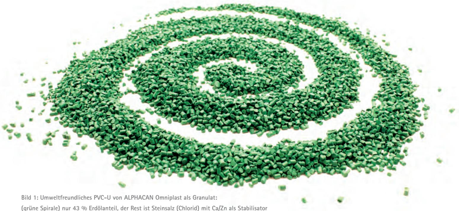
Bild 1: Umweltfreundliches PVC-U von ALPHACAN Omniplast als Granulat: (grüne Spirale) nur 43 % Erdölanteil, der Rest ist Steinsalz (Chlorid) mit Ca/Zn als Stabilisator
