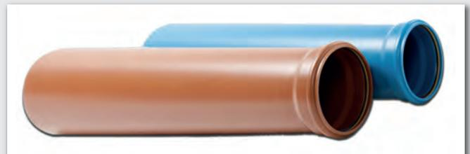
Bild 5: Das Hochlast-Kanalrohr-System „PRIMUS HL SN12“, bei dem alle Formteile SN 12 mit SDR 41 erreichen, nicht durch Verdickung, sondern durch eine Verstärkung. Durch die vollständige Einhaltung der DIN EN 1401-1 sind alle Bauteile uneingeschränkt bauaufsichtlich zugelassen
