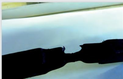
Probekörper nach Zeitstandbruch in der Schweißebene.
