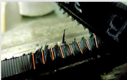
Bruchbild einer SIMOFUSE® Schweißprobe im Torsionsscherversuch.
