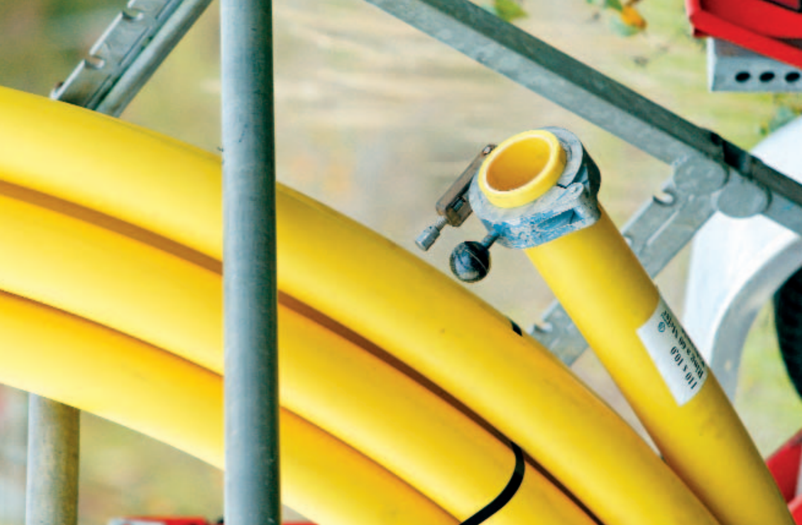
Von der Kraftstoffleitung im Auto zum Hochdruck-Gasrohr: Der Durchmesser des extrudierten Rohres ist um ein Vielfaches höher.
