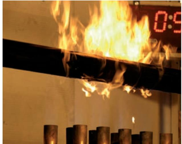
Brandtest an einem Kunststoffrohr nach IMO 753 Standard
