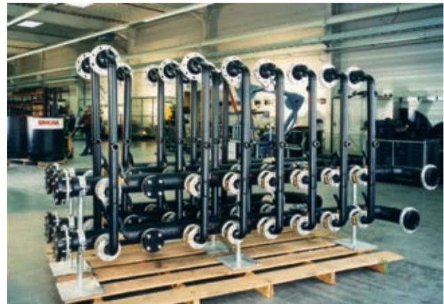
Sammelbalken aus elektrisch leitfähigem Polyethylen
