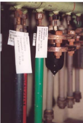
Bild 1: PVC-U-Rohre 32x2,4 mm Wavin und Dynadur seit 21.07.1959 bzw. 24.11.1956 bei 20°C unter 35 bar Innendruck (20,4 N/mm<sup>2</sup>) am 22.04.2002
