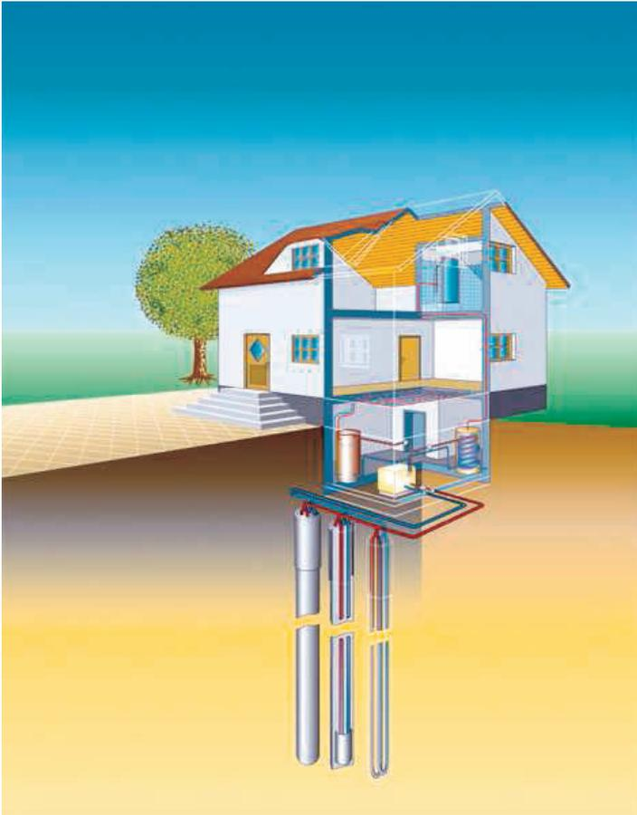
Abbildung 2: Systemskizze einer Erdwärmesonde [22]
