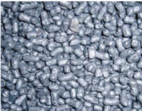
Abbildung 13: Tonpellets zur Verfüllung des Ringraumes [30]
