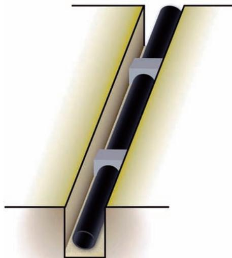
Für die Druckprüfung sind nach Möglichkeit die Rohrverbindungsstellen freizuhalten.
