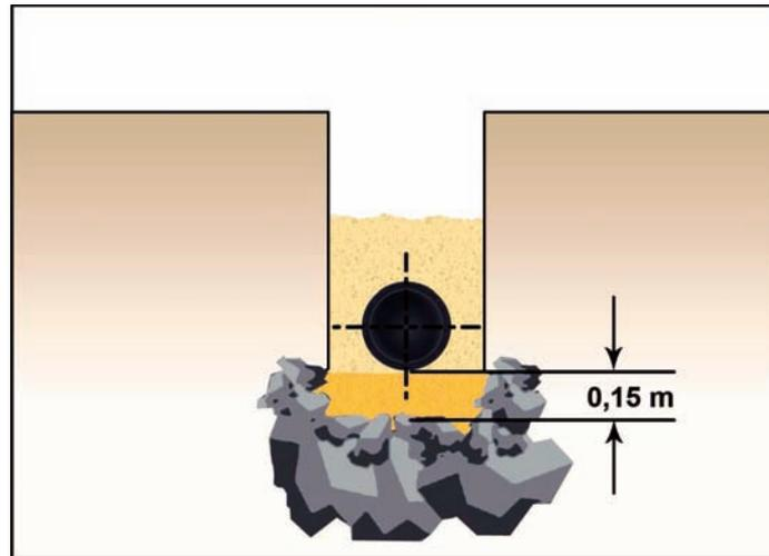
Bei nicht tragfähiger und stark wasserhaltiger Grabensohle sowie der Gefahr des Ausspülens des einzubringenden Verfüllmaterials durch wechselnde Grundwasserstände ist durch geeignete Maßnahmen eine Stabilisierung sicherzustellen.
