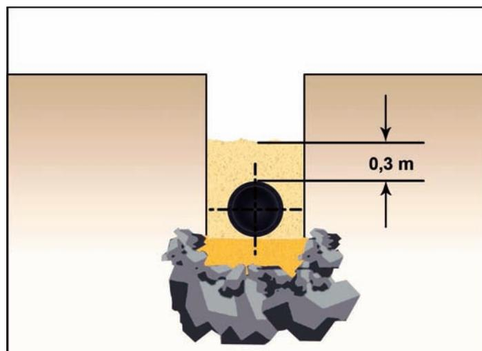
Die Rohrgrabensohle ist vor dem Verlegevorgang mit leichtem Verdichtungsgerät abzurütteln.
