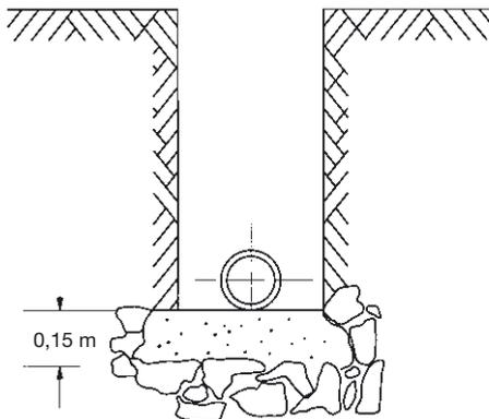
In Steilstrecken muss durch geeignete Sicherungen vermieden werden, dass der verfüllte Rohrgraben als Drän wirkt und dadurch die Rohrbettung abschwemmt und die Rohrleitung
