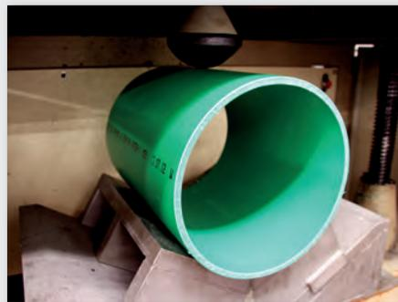
**Untersuchung des Verformungsverhaltens** von Verbindungssystemen (PE 100-Rohre DN 225, SDR 17) im Rahmen einer EBA-Zulassung. Das Ergebnis zeigt keine Risse oder sonstigen Schäden.
