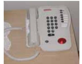
Dank der automatischen Notruferkennung wird der Hilferuf auch dann gehört, wenn die Person nicht mehr in der Lage ist selbst zu sprechen.
